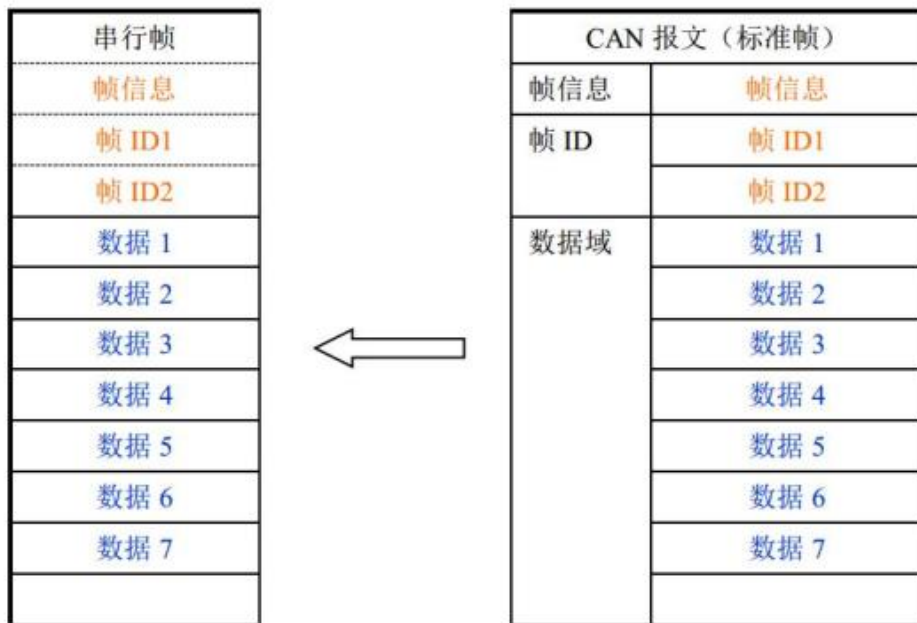
图 4.2 CAN 报文转换成串行帧 (透明方式)
