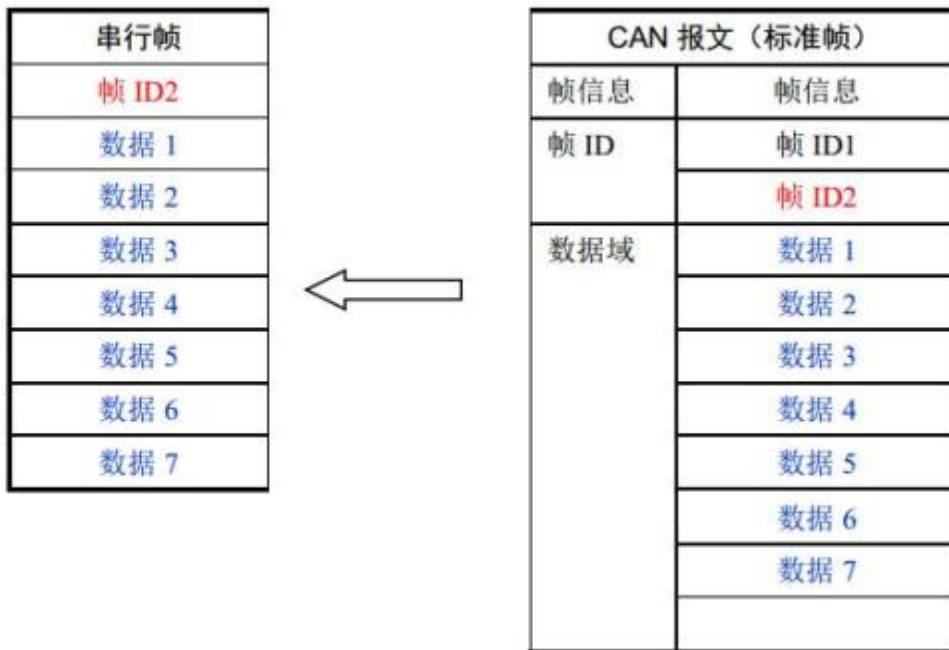
图 4.4 CAN 报文转串行帧 (透明带标识)
